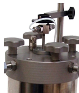
图3 GDS Rowe & Barden 固结压力室外置轴向位移测量
