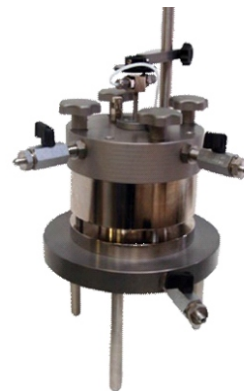
图4 GDS Rowe & Barden 固结压力室
